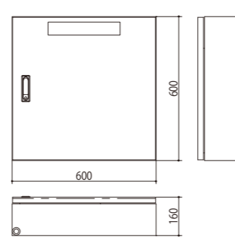
防爆仕様コントローラー 【外観寸法図 電気コントローラー】
