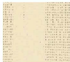
綿 wata 透光率 24% Mansel value(マンセル値) 紫外線カット率 92% (H)3.79Y(V)8.98(C)2.18
