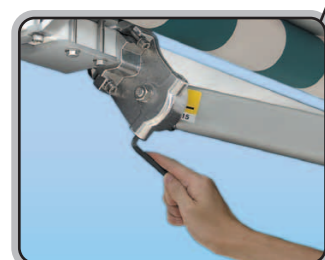
■アームブラケット (90°まで対応) 上下のボルトでキャンバスの角度を調整し、アームを固定します。
